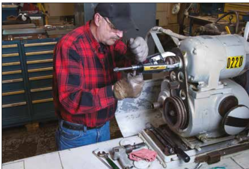
◀ Установка трехзахватного зажимного съемника EP-104 на ведущем шкиве электродвигателя.
